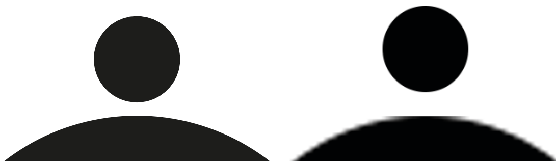
Obrázek 1b: Ukázka rozdílu mezi vektorem a bitmapou. Vlevo vektory, vpravo bitmapa. Po pětinašobném zvětšení (viz spodní část obrázku) je patrné, že bitmapa má algoritmem dopočítané zaoblení.
