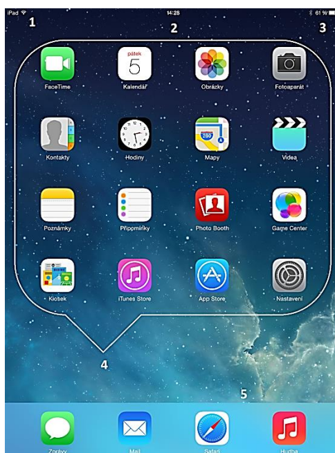
Obrázek 7: Úvodní obrazovka (Legenda: 1 – stav Wi-Fi signálu, 2 – čas, 3 – stav baterie, 4 – ikony aplikací, 5 – rychlá nabídka)
