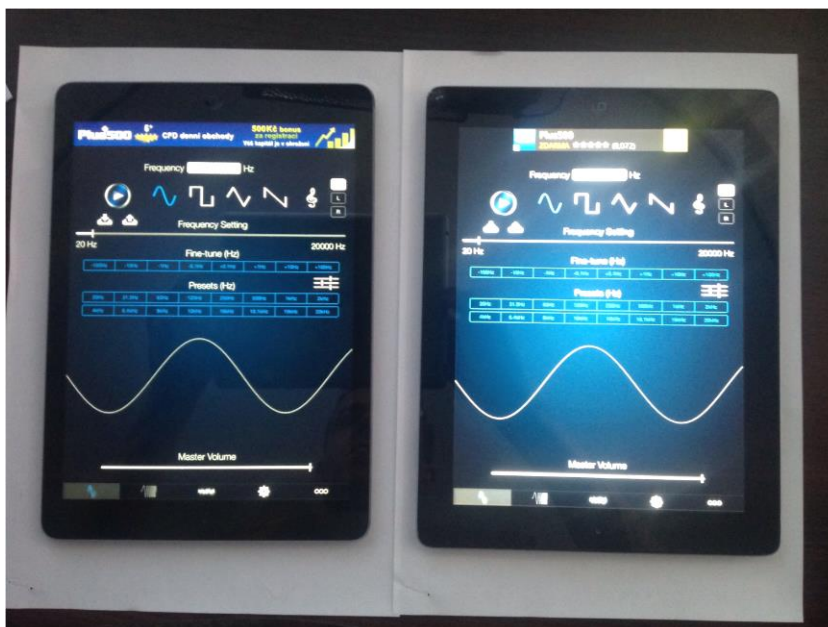
Obr. 19: Dva tablety jako generátory zvukových vln
