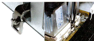
Přítlačnou pružinu na jedné straně zahákneme za plastový úchyt
