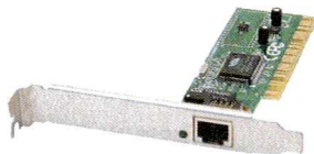
Síťová karta pro připojení kabelem (kroucená dvojlinka)
